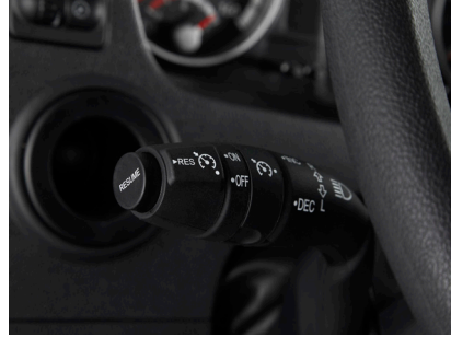
좌측 콤비네이션 스위치 : 등화류 조작 및 크루즈 컨트롤 작동
