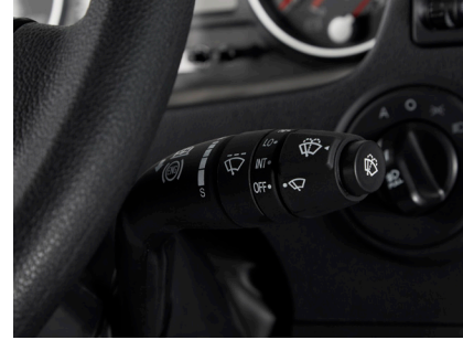
우측 콤비네이션 스위치 : 와이퍼 조작 및 배기 브레이크 작동
